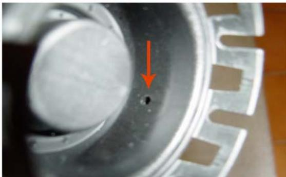
Durch diese kleine Loch wird der Unterdruck erzeugt.
